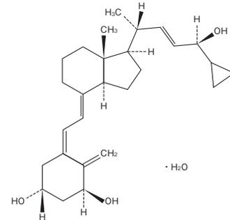
分子式：C<sub>27</sub>H<sub>40</sub>O<sub>3</sub> · H<sub>2</sub>O
